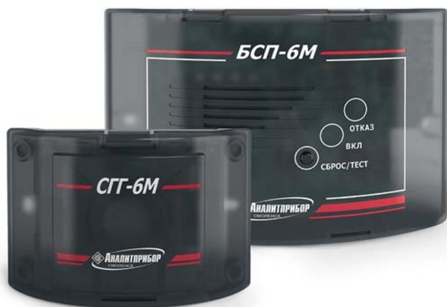
Предназначен для непрерывного автоматического контроля содержания природного и сжиженного газов; выдачи световой и звуковой сигнализации в случае возникновения в помещении дозврывоопасных концентраций газов; перекрытия газопровода быстродействующим электромагнитным клапаном.
